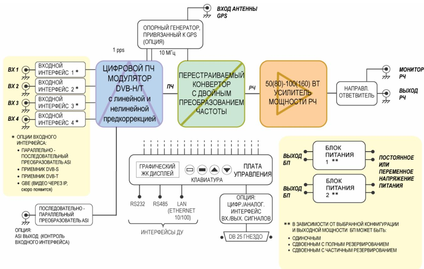
Передатчик серии DTX состоит из цифрового модулятора, перестраиваемого конвертора и широкополосного усилителя мощности. Вместе с блоком питания и охлаждающей системой весь передатчик умещается в одном корпусе для стойки 19" высотой 3U.
