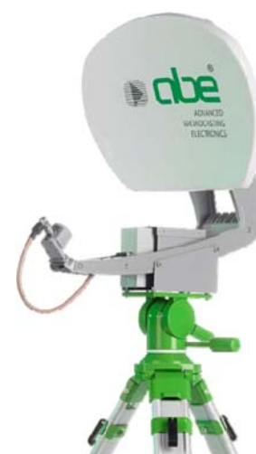
РРЛ серии DML компании ABE Elettronica Переносной модуль на треноге для мобильного применения
