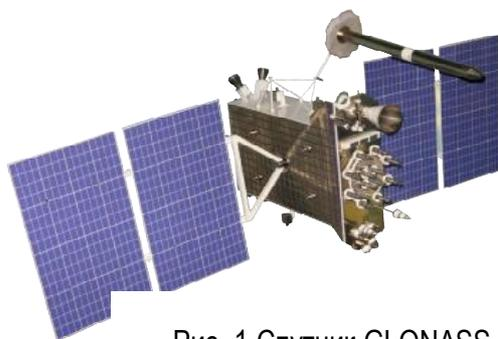
Рис. 1 Спутник GLONASS
