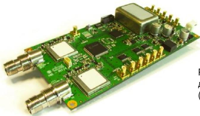
Рис. 2 Плата синхронизатора GNSS с двумя приемниками для двух стандартов (GPS+GLONASS) и опорный генератор
