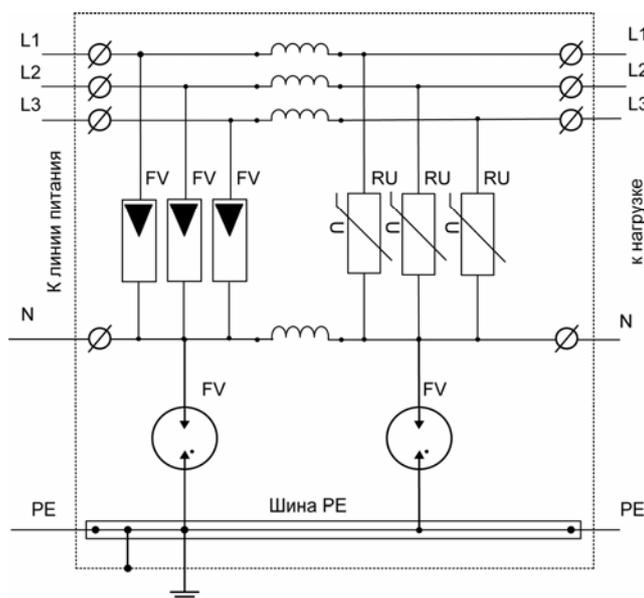
Рис. 1. Схема УЗИП - 3
