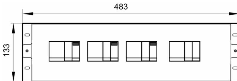
Рис. 2. Внешний вид и габаритные размеры УЗИП - 3
